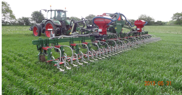
Kamerastyret radrenserer med arbejdsbredde på 12 m. (Klik på billedet for stor udgave) Foto: Kathrine Hauge Madsen, Videncentret for Landbrug, Økologi
